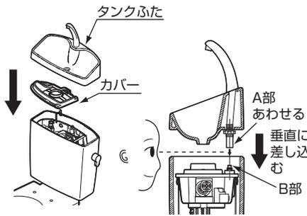
5 止水栓を開け、2~3度洗浄させて、便器・タンク内外への水漏れなどの異常がないことを確認する。
