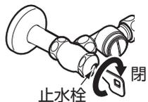
② モンキーレンチで袋ナットを『締まる』の方向に回して締め増しする。
