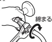
③ 止水栓を開けて、水漏れがないか確認する。
