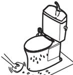
便器やタンクおよび給水管や止水栓の表面が結露した場合、乾いた布でふき取る
