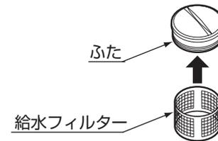
**5** 給水フィルターを元の位置に取り付け、ふたを開閉工具で締め付ける。
