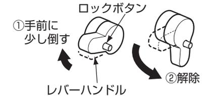
2 水抜き栓を操作して給水を止める。
