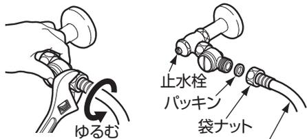
※給水フレキホース内の水が少し流れ出しますので、バケツなどの容器で受けてください。
