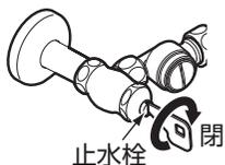
② モンキーレンチで袋ナットを『ゆるむ』の方向に回して外し、給水フレキホースを外す。
