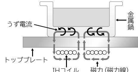
IHとは電磁誘導加熱(Induction Heating)のこと。IHコイルから発生した磁力(磁力線)が、金属製の鍋を通ると、うず電流が発生し鍋自身を発熱させます。
