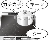
●使用中や使用後しばらくは、本体内部の温度上昇を抑えるために冷却ファンを回します。（最大約90秒）そのため冷却ファンの音と本体から少し風が出ます。異常ではありません。
